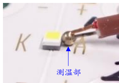
热电偶丝径大、测温部形状过大
