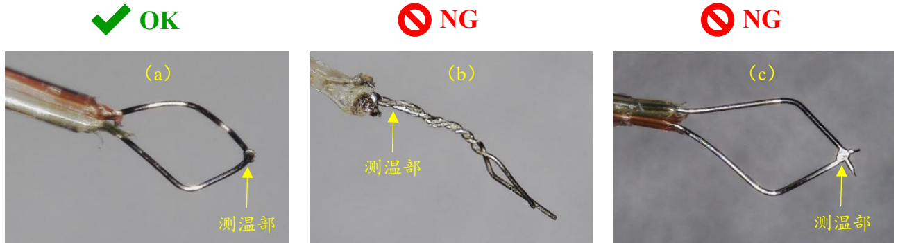
图 3 热电偶的测温位置
